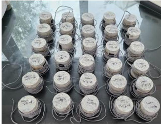
그림 B.1 — 단체표준에 따라 제작한 공시체 예시
